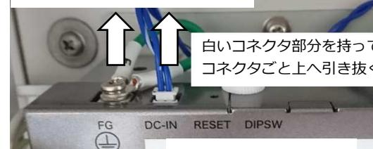
通信機器下部の LAN ケーブルとアンテナが外します。ケーブルを抜き終わったら、取付金具の下を通っているアース線と電源ケーブルを抜いて、通信機器を取付け金具ごと BOX から取り出してください。
