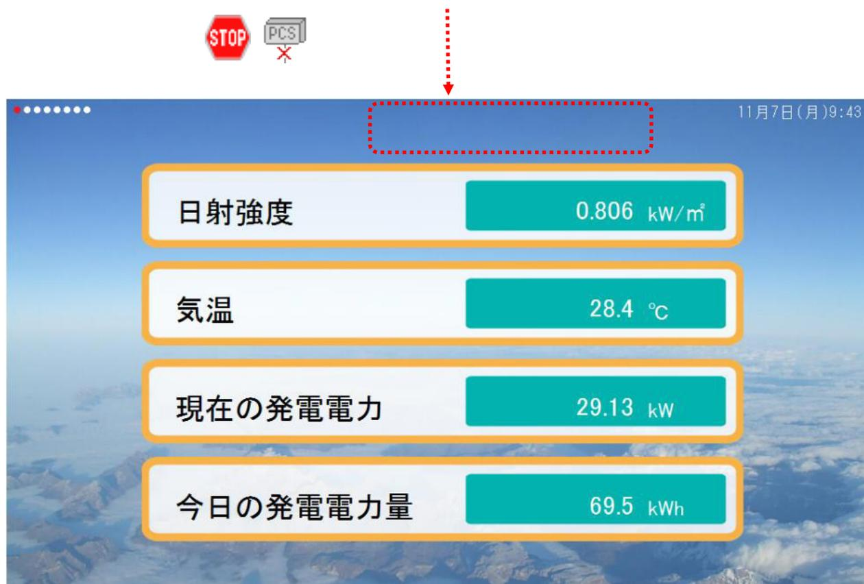
「サービス停止」「パワコン通信異常」のアイコンが表示されておらず、計測値が正常に表示されていれば、初期設定は完了です。
